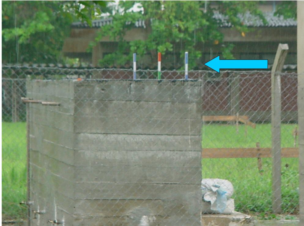
Fotografia 19 - Régua utilizada para o monitoramento da altura da lâmina de lodo
