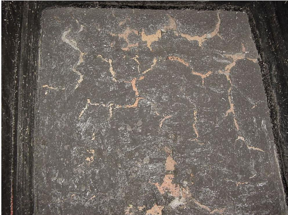
Fotografia 24 - Torta seca do leito de secagem C45-I no último dia do experimento
