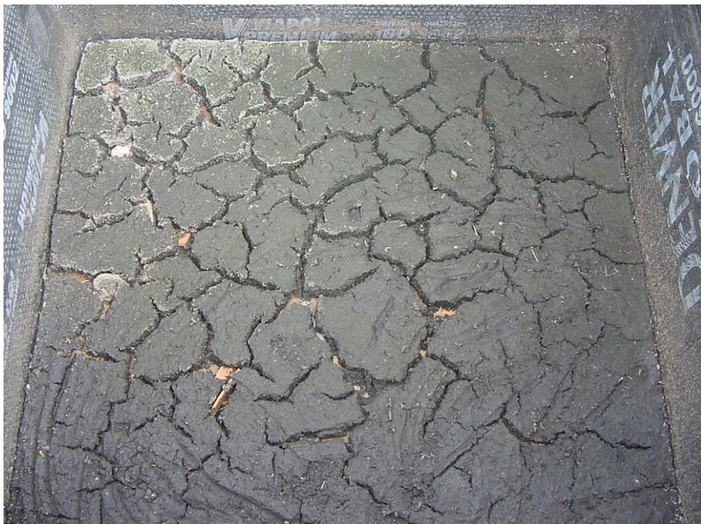
Fotografia 33 - Torta do leito de secagem descoberto dia 28/10/2002 (teor de umidade 75,5)
