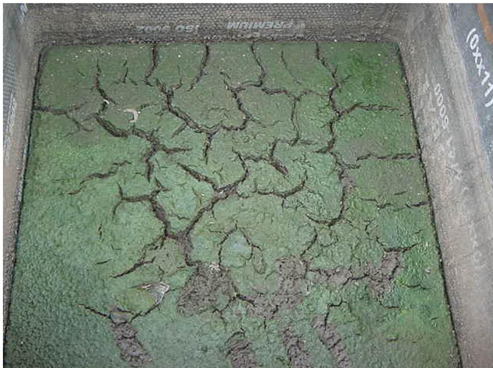
Fotografia 35 - Torta do leito de secagem descoberto dia 16/01/2003 (teor de umidade 81,5%)
