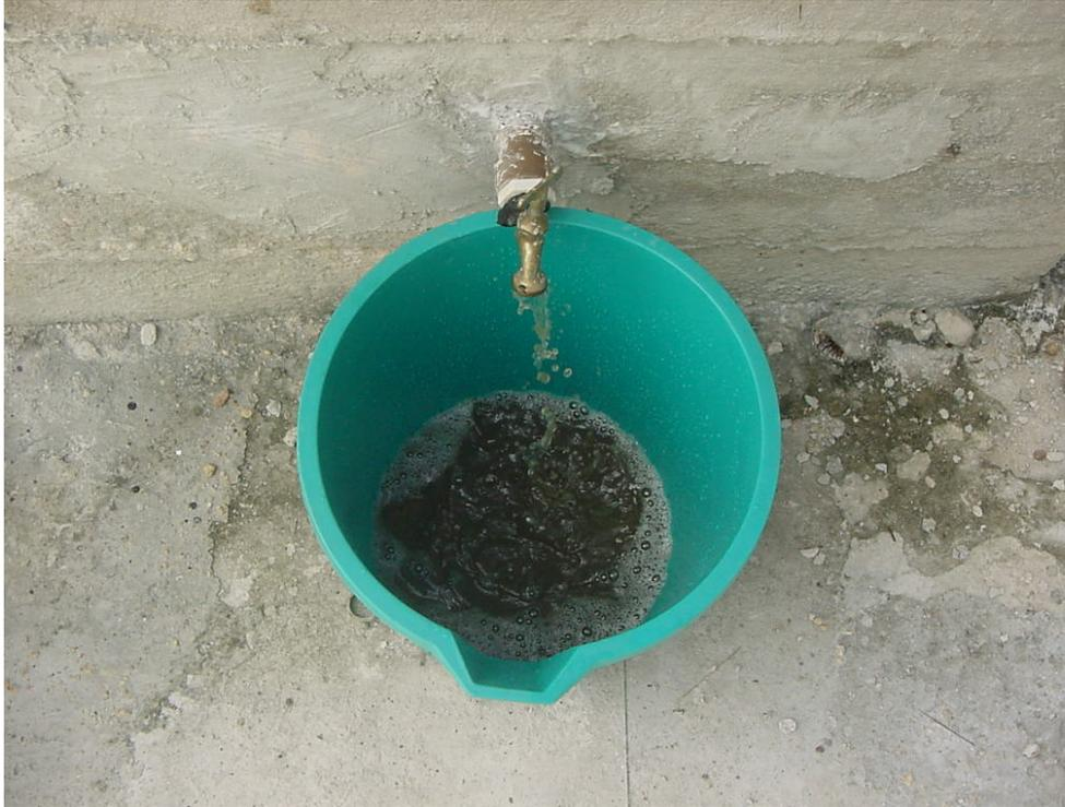
Fotografia 18 - Coleta de líquido drenado no leito de secagem descoberto
