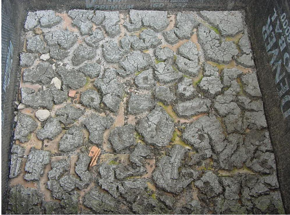
Fotografia 23 - Torta seca do leito de secagem D45-I no último dia do experimento
